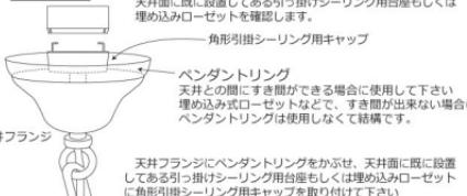
天井フランジにベンドントリングをかぶせ、天井面に既に設置している引掛けシーリング用台座もしくは埋め込みローゼットで、角形引掛けシーリング用キャップを取り付けて下さい。しっかりとロックがかかるまで確実に取り付けて下さい。
