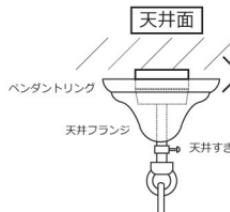
しっかりと天井部分に取り付けた後、天井フランジと天井部分のすき間調整を天井すき間調整リングのナットを固定して行って下さい。
