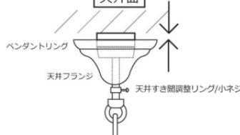
しっかりと天井部分に取り付けた後、天井フランジと天井部分のすき間調整を天井すき間調整リングのネジで固定して下さい。
