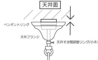
しっかりと天井部分に取り付けた後、天井フランジと天井部分のすき間調整を天井すき間調整リングのナットで固定して下さい。
